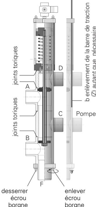
desserrer écrou borgne (loosen lock nut) / enlever écrou borgne (remove lock nut)
