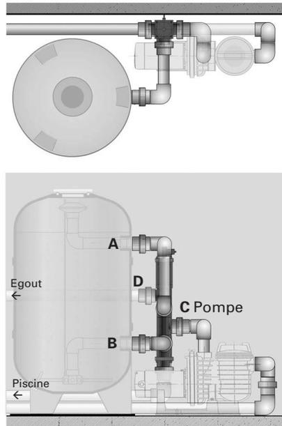
Les vannes **besgo** à partir de DN65 / DN80 et DN100 devraient être montées au mur moyennant des colliers pour tuyaux (vous incombant).
