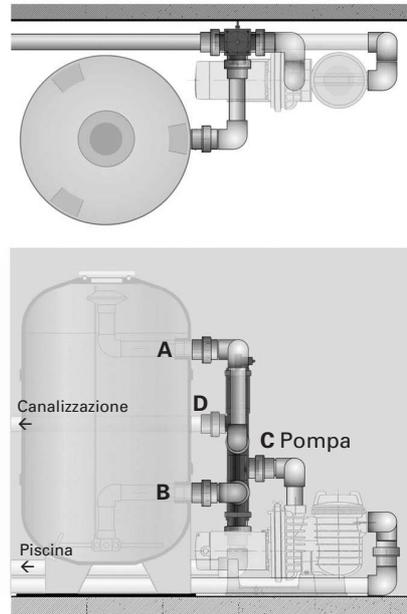
VALVOLE **besgo** dal DN65 / DN80 e DN100 dovrebbero essere fissate con delle brida alla parete.
