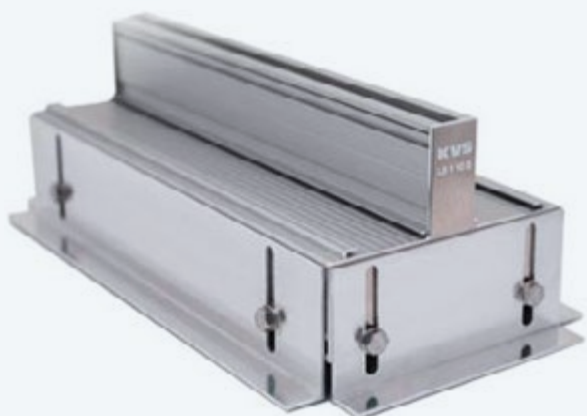
Symmetrische Lüftungsschiene aus natureloxiertem Aluminium – formschöne, dezente Lösung für die Zuluft einbringung direkt an der Glasfläche. Sorgt für gleichmäßige Luftverteilung und verhindert Kondensation im Fensterbereich.
